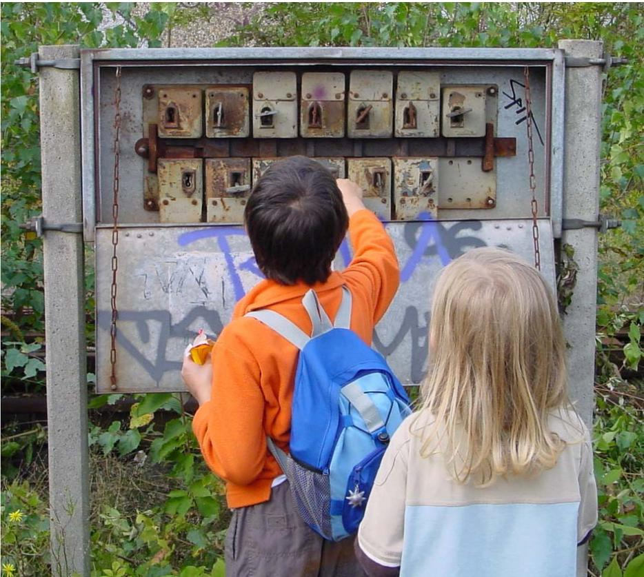
Der Schlüsselkasten vorm Stellwerk Loh. Mit Hilfe einer rein mechanischen Lösung konnten die Lokomotivführer nach Schließung der Stellwerke sich verständigen, wer auf welchen Streckenabschnitt durfte.
